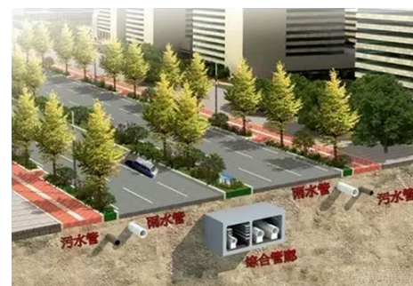
地下综合管廊建设剖面示意图
